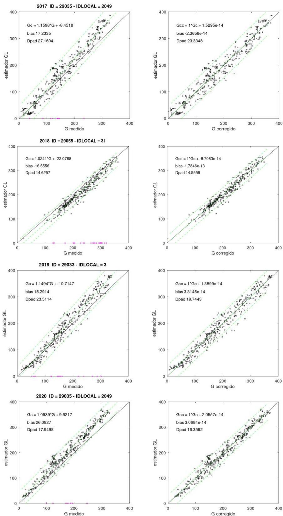
**Figura 3.** Ejemplos de comportamiento de estaciones en 4 años diferentes. Izquierda: diagrama de dispersión  $GL|G$  ( $G_c$  se refiere a la recta de regresión lineal); puntos rosados en el eje x indican casos con ausencia de valor  $GL$  (no incorporados a la estadística). Derecha: diagrama  $GL|G^*$ . bias: desviación media MBE; Dpad: desviación estándar  $S$ .  $G_c$  y  $G_{cc}$  se refieren a las respectivas rectas de regresión lineal.
